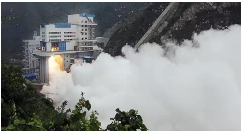
图14: 120吨级液氧煤油发动机试车成功
