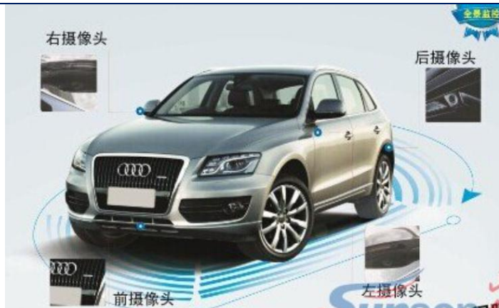
图 30、汽车摄像头安装位置
