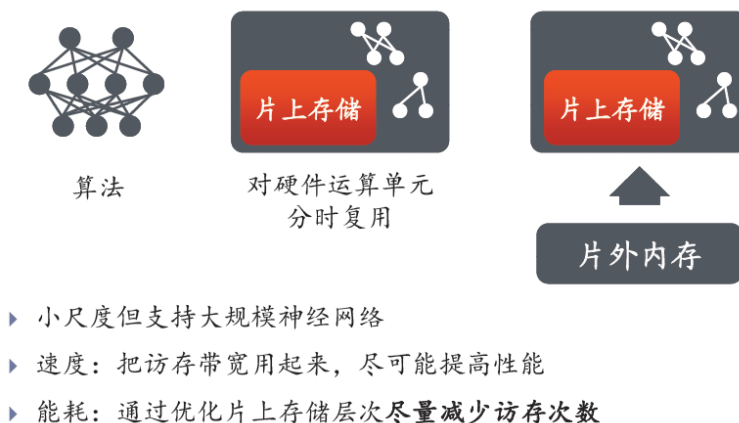
图 6：通过改变芯片架构、优化片上存储层次，降低访存次数、提升性能
