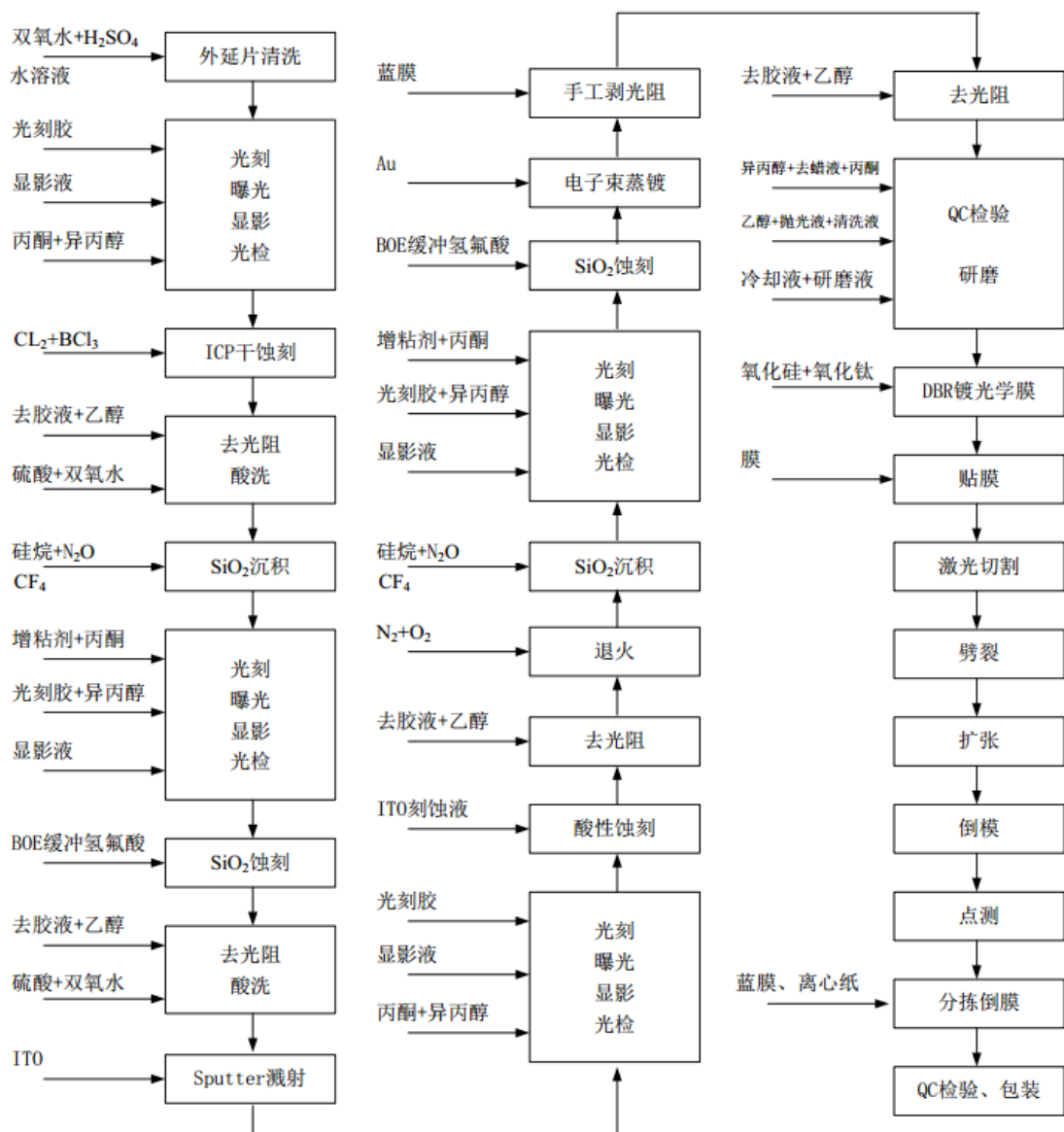
图 2: LED 芯片工艺流程示意图
