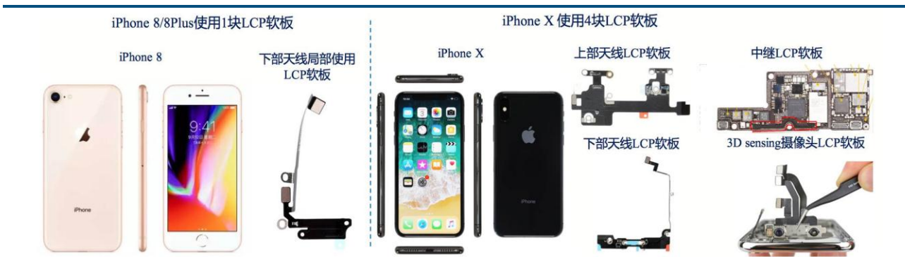
图 1: 旗舰机 iPhone X 用了 4 倍于中端机 iPhone 8/8Plus 的 LCP 软板
