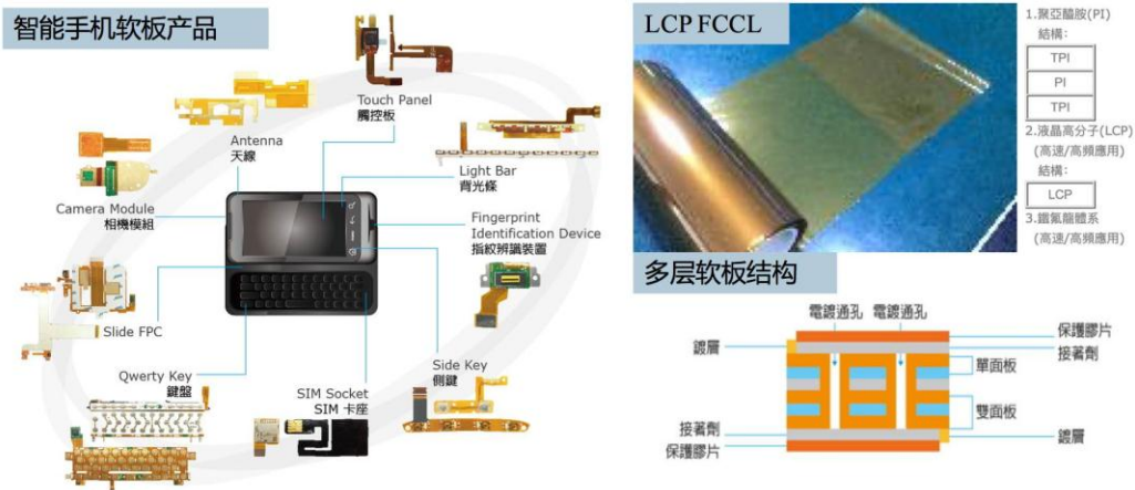
图 41：嘉联益的智能手机软板产品、LCP FCCL 与多层软板结构
