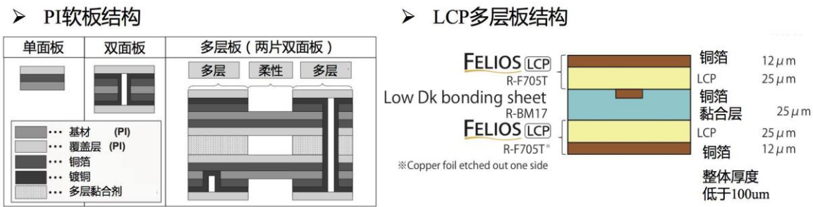
图 10: PI 软板与 LCP 软板的剖面结构
