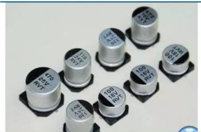
图 16：贴片铝电解电容器
