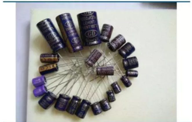
图 17：插脚铝电解电容器
