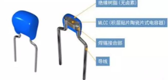
图 11：引线式多层陶瓷电容器结构图
