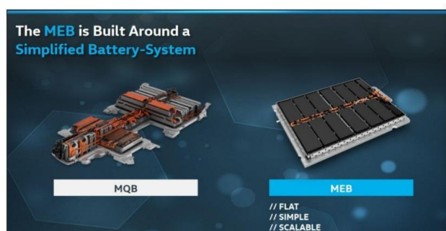
图 10：大众 MEB 平台兼容圆柱、方形、软包电池
