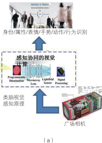
图6 三维光场相机及其原理示意图（a）和主动仿生双眼视觉系统（b）
